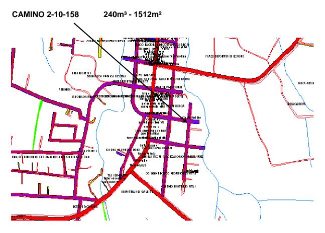
Construcción de aproximadamente 1512 m² de losa de concreto en una longitud de 0,275 Km con un ancho promedio de 5.5 m y un espesor de 0.15 m de acuerdo con la sección típica, para lo cual se requiere fabricar 240 m³ de concreto con una resistencia de 225 kg/cm² compresión.
